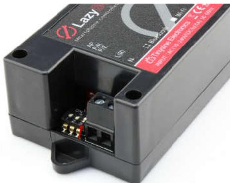
**2. AC Input Port:** AC power input. Working voltage AC100~240V.
